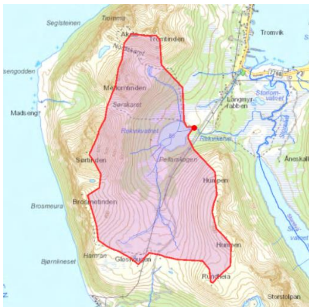
Figur 4. Figuren viser nedbørsfeltet til Rekvikvatnet (generert i Nevina). Rekvikvegen krysser gjennom nedbørsfeltet og deler det i to.
